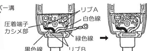
傾斜センサー用リード線（緑）圧着端子は左上図のように直横に向けてください。
