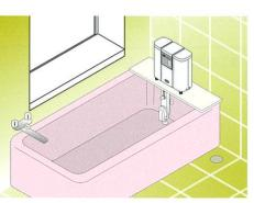
浴槽上設置タイプ 浴槽上の壁面側に人工ボード(別途実費) を固定し、その上に設置します。
